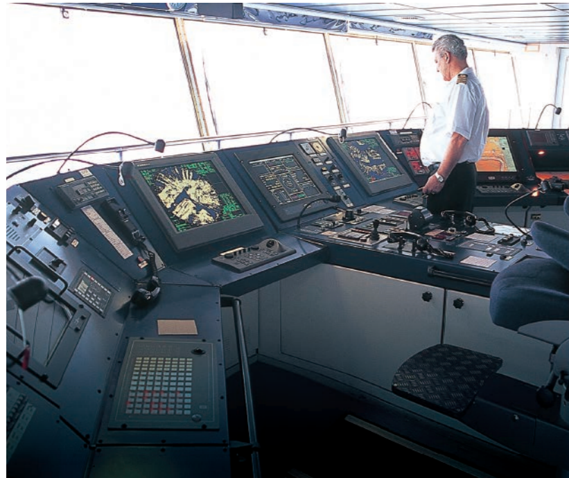
統合航海システム レーダーなど各種航海機器のデータがリンクしながら、一つの計器のように作動するシステムです。
