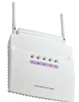
無線LANアクセスポイント 契約している携帯キャリアにかかわらず、無線でインターネットに接続できます。
