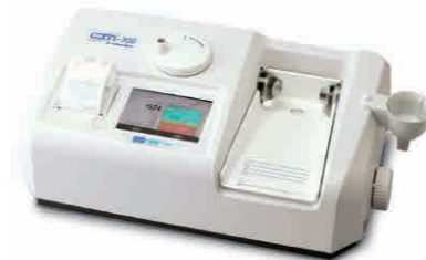
超音波骨密度測定装置 かかとの骨に超音波をあてることで、安全・手軽に骨密度を測定できます。
