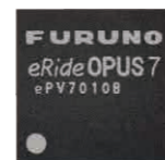
GPS (GNSS) 受信機 高感度かつ小型・軽量で、カーナビをはじめ、さまざまな携帯機器に組み込めます。
