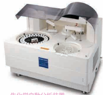
生化学自動分析装置 血液の成分を測定する検査機器で、健康診断などで用いられます。
