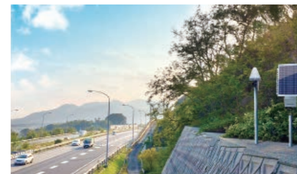
GNSS自動変位計測システム「DANA」の外観。左がGNSSセンサー、右がソーラー電源
