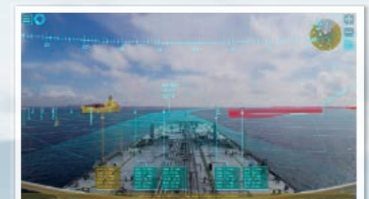
ARナビゲーション映像イメージ。方位、AIS、自船位置・針路・船速、ルートやウェイポイントなどの情報が重畳表示される
