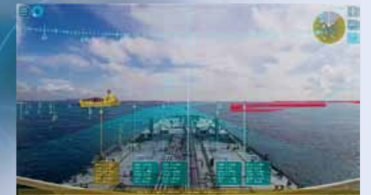
ARナビゲーションシステム映像イメージ。方位、AIS、自船位置・針路・船速、ルートやウェイポイントなどの情報が重畳表示される
