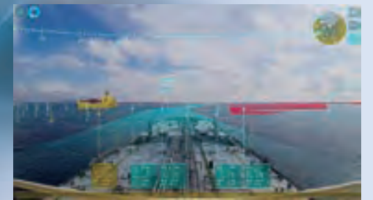
ARナビゲーションシステム映像イメージ。方位、AIS、自船位置・針路・船速、ルートやウェイポイントなどの情報が重畳表示される
