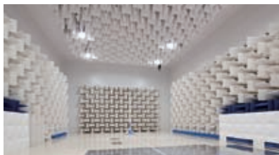
10m法電波暗室
