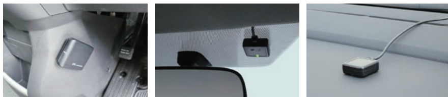
本体は運転席や助手席の目立たない場所に（左）、アンテナはフロントガラス（中央）や、ダッシュボード（右）に設置できます。
