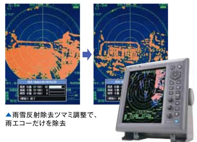
▲雨雪反射除去ツマリ調整で、雨エコーだけを除去
