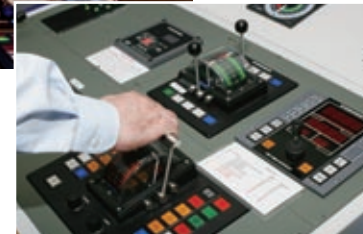
運行量や海況などを自由に設定できる操船シミュレーターを使い、実際の操船環境に近い環境でトレーニングを行います。
