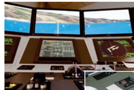
運行量や海況などを自由に設定できる操船シミュレーターを使い、実際の操船環境に近い環境でトレーニングを行います。
