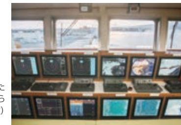
「第八十八光洋丸」に搭載された最新鋭の航海機器。上段の左から2つ目(低周波)と3つ目(高周波)が「FSV-28WL」。
